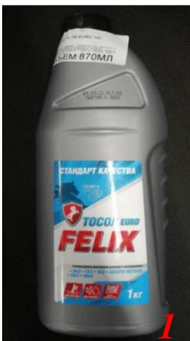
**Фото 1** – нарушение по показателю безопасности «температура начала кристаллизации»: при норме не выше минус 35°C показатель составил минус 30,5°C
